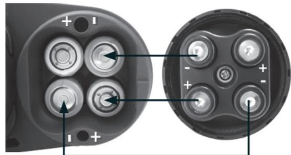
Beachten Sie beim Einlegen der Batterien die Polaritätsangaben im Batteriefach und stellen Sie sicher, dass beim Aufsetzen des Deckels die Polaritätsangaben am Deckel den Polaritätsangaben im Batteriefach entsprechen (+ an + und - an -).
