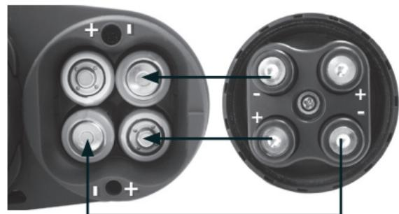
Respecter les marques de polarité des piles à l'intérieur du compartiment à piles au moment d'insérer celles-ci, et s'assurer que les marques de polarité du chapeau correspondent à la polarité du compartiment à piles lors de la repose du couvercle (+ sur + et - sur -).
