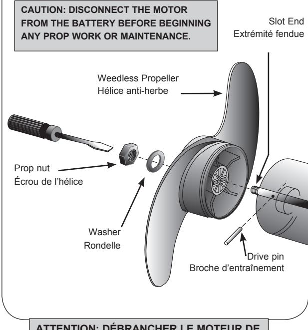
ATTENTION: DÉBRANCHER LE MOTEUR DE LA BATTERIE AVANT D'ENTREPRENDRE L'ENTRETIEN DE L'HÉLICE.
