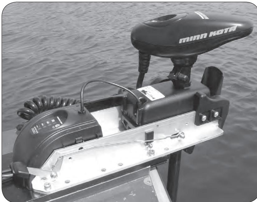
**CAUTION: MAKE SURE YOU MOUNT YOUR MOTOR ON A LEVEL SURFACE. USE THE RUBBER WASHERS TO CREATE A LEVEL SURFACE — IF NECESSARY.**
