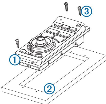
8 Si les trous de montage sur l'appareil ne sont pas alignés, repérez les nouveaux emplacements des trous d'implantation.
