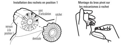
**REMARQUE** : Les mécanismes à rochet sont clavetés. Assurez-vous que les dents carrées de chaque mécanisme à rochet s'imbriquent dans celles du joint d'articulation du transducteur et que les dents triangulaires font face vers l'extérieur.
