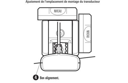
**Inclinaison vers le bas** : Il existe une déclivité naturelle de 4 à 5 degrés du bord d'attaque au bord de fuite du transducteur. D'un point de vue situé à l'arrière du transducteur, la ligne de joint devrait être légèrement sous le fond de la coque.
