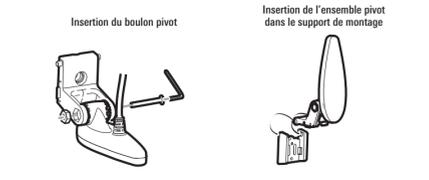
**REMARQUE** : Si l'ensemble pivot s'est refermé sous pression sur le support de montage, servez-vous d'un tournevis à tête plate ou d'un outil similaire pour disjoindre l'ensemble pivot du support de montage.
