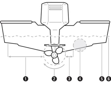
**1** Évitez les zones où il y a un écoulement d'eau turbulent. Eau turbulente se limitent normalement aux zones situées directement à l'arrière des membrures, virures ou rangées de rivets sous le bateau et dans la zone immédiate de l'hélice (des hélices). La meilleure façon de localiser un emplacement libre de turbulences est de regarder le tableau arrière lorsque le bateau se déplace.
