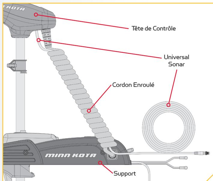
**REMARQUE:** Après que le câble de l'Universal Sonar ait été sorti du cordon enroulé, il doit être acheminé par un système d'acheminement établi sur le bateau, dans une zone libre d'interférences. Inspectez bien le chemin planifié pour vous assurer qu'il n'y a pas d'arêtes vives, d'obstacles ou d'obstructions qui pourraient endommager les câbles.
