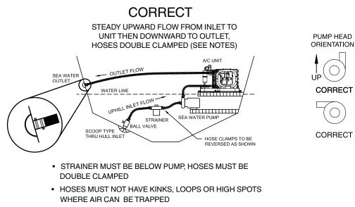
• PUMP & STRAINER MUST BE BELOW WATER LINE
