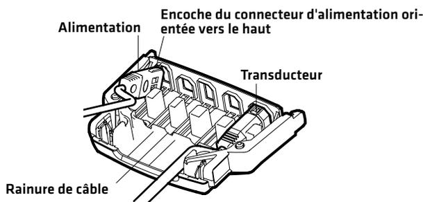
**⚠ MISE EN GARDE !** Il est important de placer les connecteurs dans les bons logements avec le bon côté orienté vers le haut. Reportez-vous à l'illustration **Description des logements du plateau de câblage** pour plus de détails.
