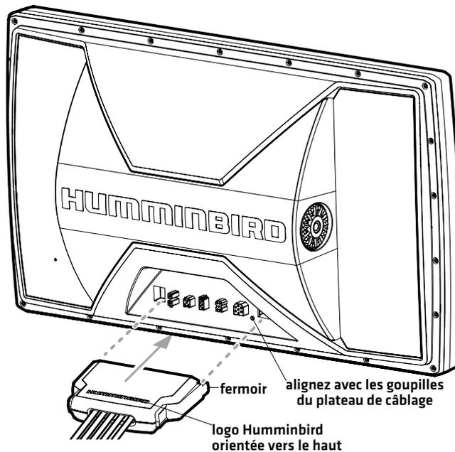
7. Tirez doucement sur le plateau de câblage pour confirmer l'installation est sécurisé. Assurez-vous que les deux fermoires cliqué en place à l'étape 7.
