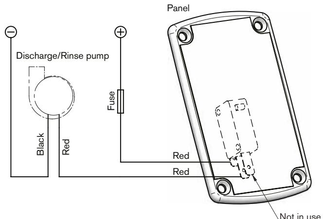
Pannello superiore sul filo rosso (switch) al positivo (+) della batteria tramite un fusibile pannello inferiore del filo rosso (switch) sul rosso Wc pompa pompa per wc Nero a batteria negativo (-)
