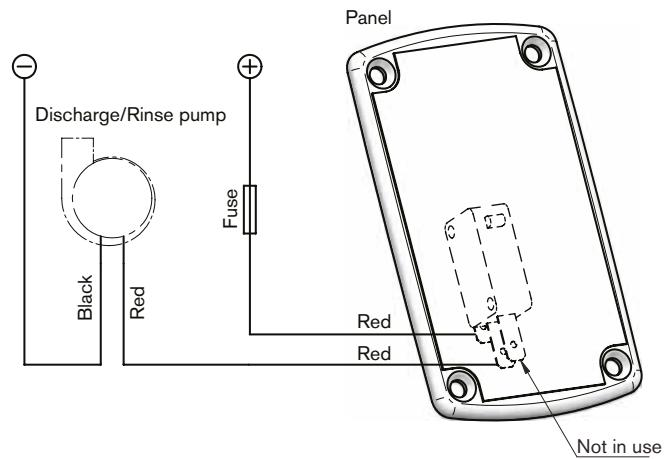
Panel Röd (övre ledning på omkopplaren) till plus (+) på batteriet via en säkring.
