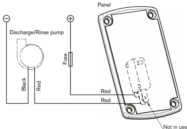
17mm rouge (fil supérieur sur le commutateur) au positif (+) batterie via un fusible Pompe panneau rouge (en bas de fil sur l'interrupteur) à la toilette rouge Pompe pour WC Noire à la batterie négatif (-)
