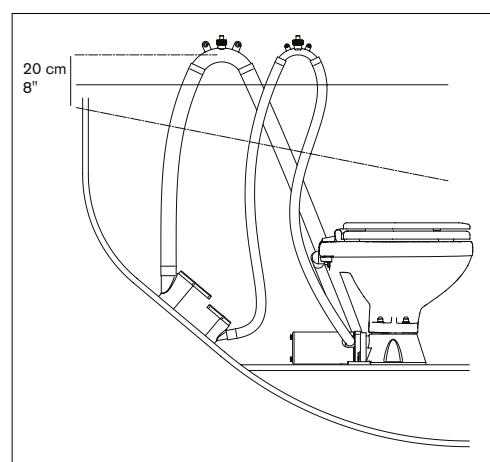
Sie benötigen einen 19 mm (3/4") Belüftungsstutzen.
