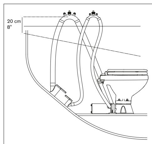
Debe utilizar un 19 mm (3/4") ventilados Bucle adecuado.
