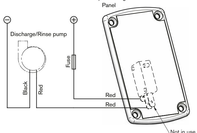
Panel-Rot (obere Draht-Schalter), um positive (+) Batterie über eine Sicherung Panel-Red (untere Draht-Schalter) zu WC-Pumpe rot WC-Pumpe Schwarz, um die Batterie Minuspol (-)
