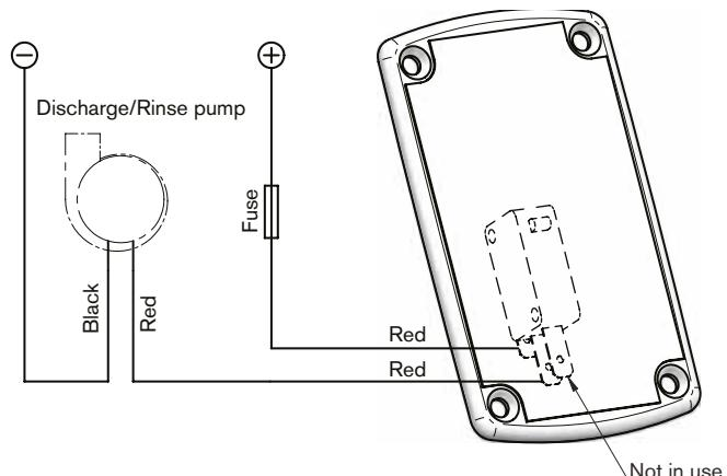
Panel superior roja (alambre de switch) de positivo (+) batería mediante un panel de fusibles Network (menor wire en switch) roja bomba de baño higiénico Negro bomba de batería negativo (-)
