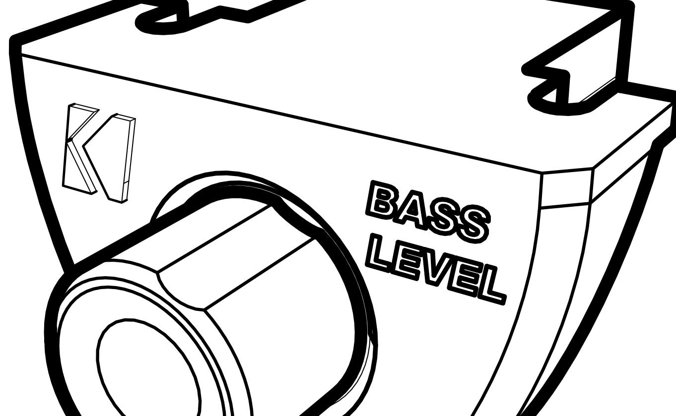
Montez la télécommande CXARC en surface à l'aide des vis fournies.
