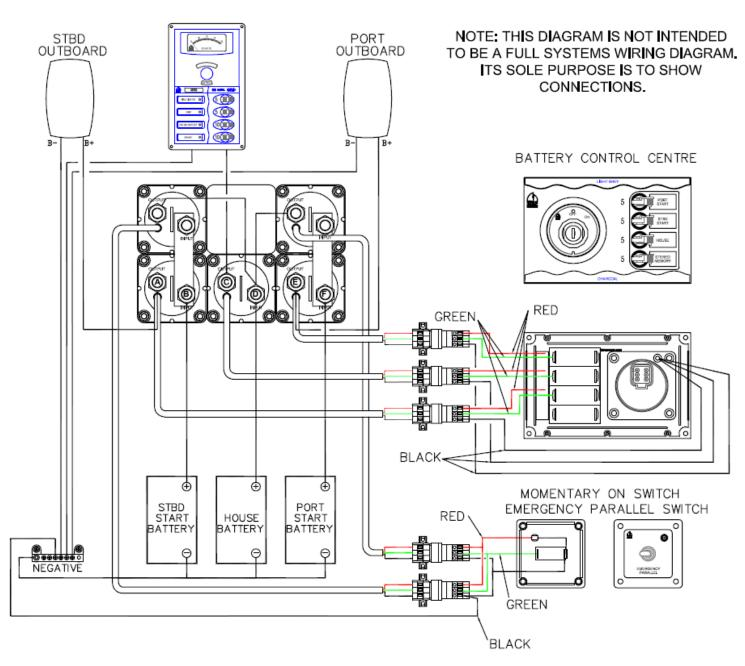
STUD A- CONNECT TO THE POSITIVE TERMINAL OF THE STBD OUTBOARD MAIN.
