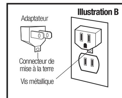
L'utilisation d'un adaptateur est interdite au Canada. Si une prise de courant avec mise à la terre n'est pas disponible en faire installer une par un électricien qualifié avant d'utiliser cet appareil.
