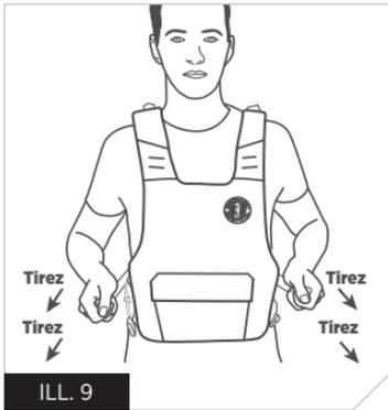
3. Chacune des sangles supérieures et inférieures doit être serrée. Saisissez le bout de la sangle de taille supérieure ou inférieure de chaque côté et tirez vers l'avant. Répétez avec l'autre sangle.
